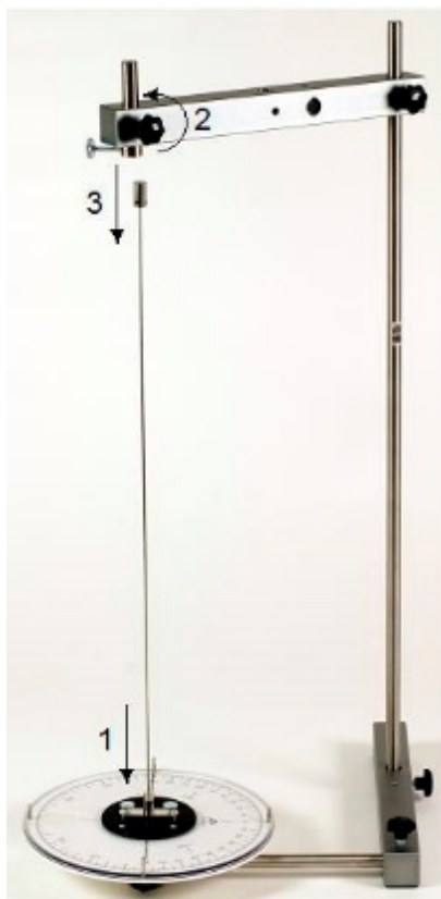
Рис. 13.5. Первый этап смены стержня: крепление цилиндрического стержня к диску винтами 1 с помощью зажимного рычага и зажимной втулки.
