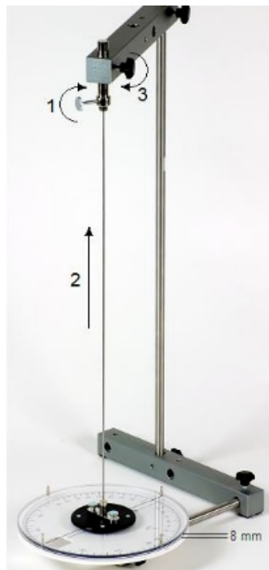
Рис. 13.6. Второй этап: крепление стержня винтами 1, 3 к зажимной втулке и регулировка рабочего расстояния (около 8 мм) между диском маятника и диском шкалы.
