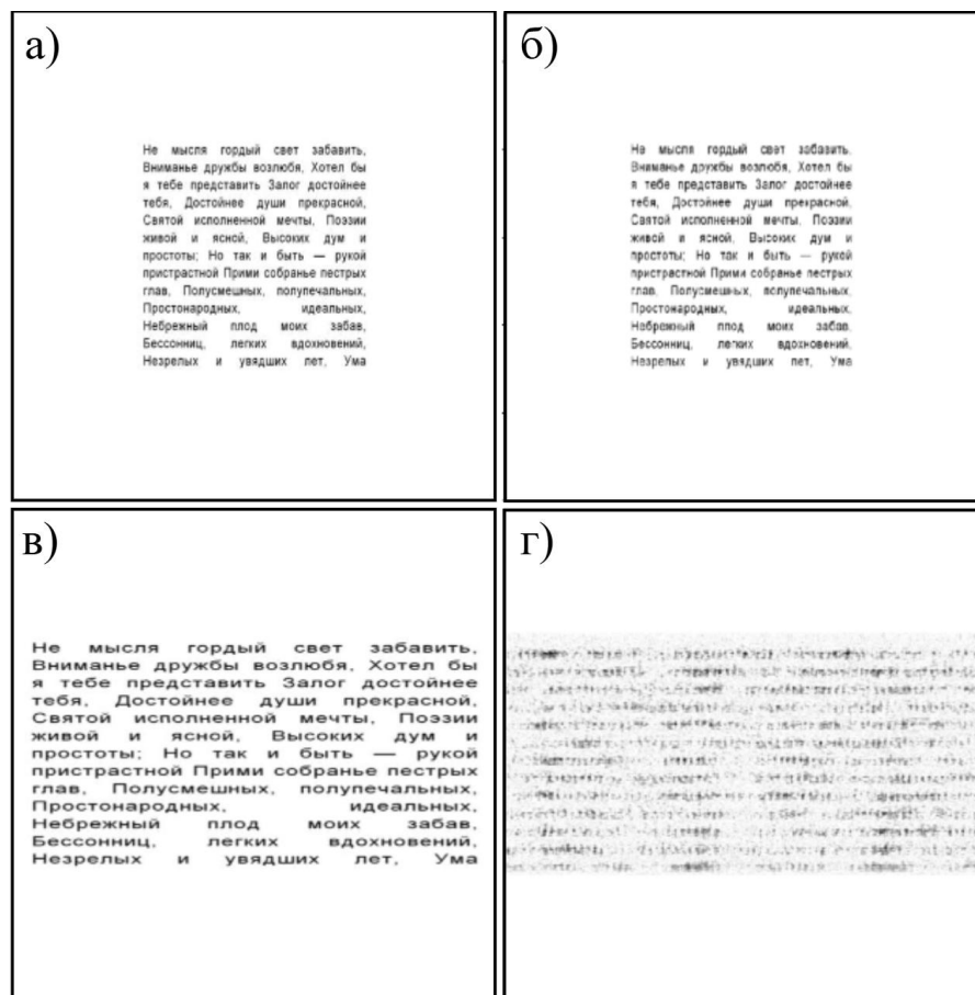
Рисунок 9. Влияние коэффициента пероопределенности на результат восстановления изображения. Буквами обозначены: а – исходное изображение с \sigma = 2 для всех направлений; б – результат восстановления изображения а ; в – исходное изображение, в котором условие оверсэмплинга было нарушено вдоль горизонтального направления; г – результат восстановления изображения в
