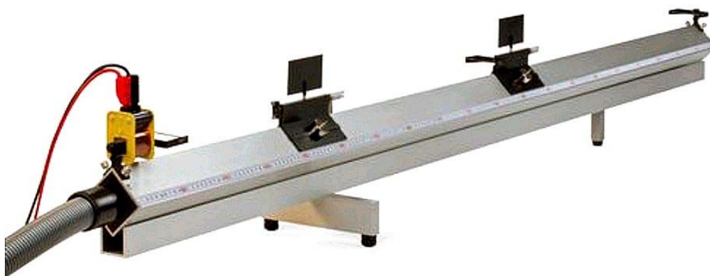
Рис. 1.3. Общий вид воздушной скамьи (показано две каретки).
